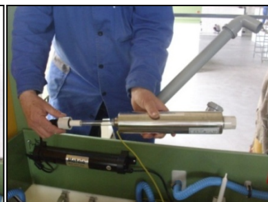
Fig. 13: UV-lampen legges inn i etui
