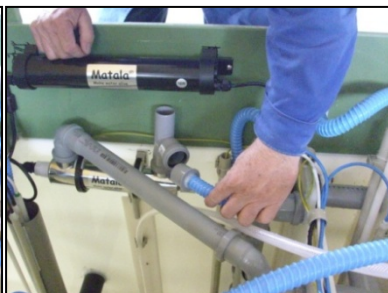
Fig. 17: Tilkobling av vanntilførsel
