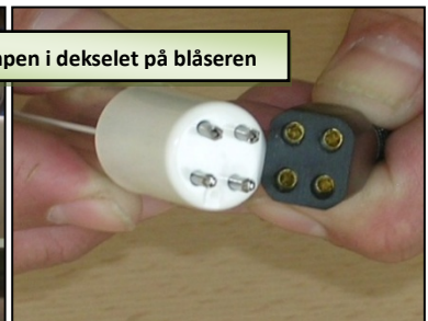
Fig. 11: Detalj med UV-lampepinner og støpsel
