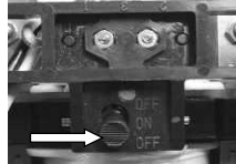
Aktivovaný spínač na ochranu membrány (Čerpadlo sa nespustí.)
