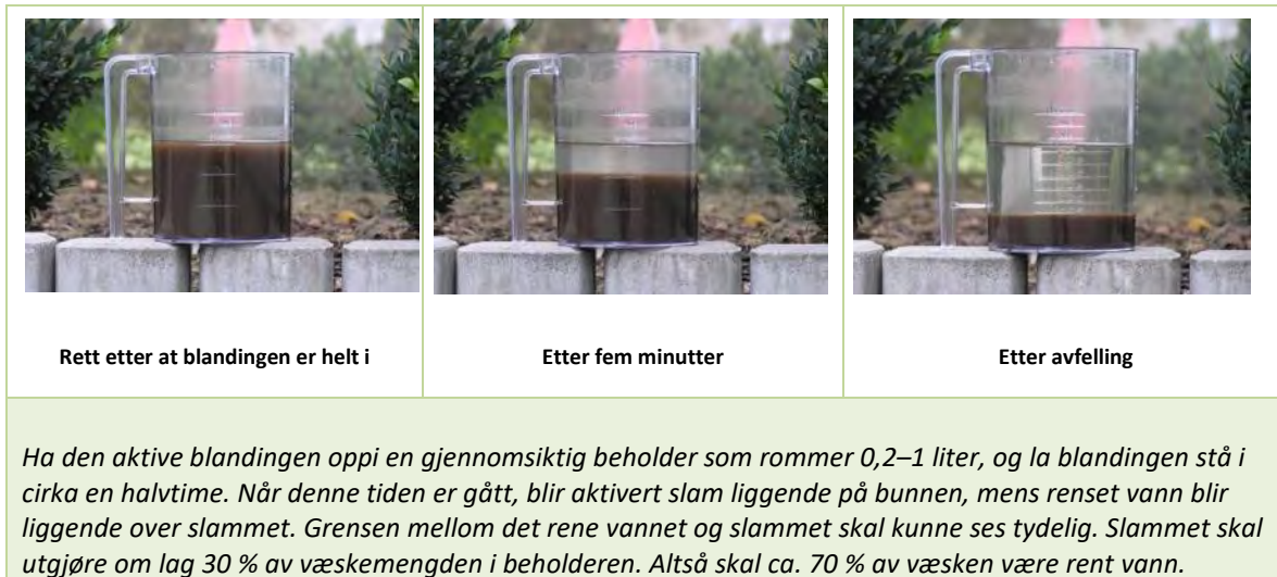
Fig. 8: Kontroll av slammengden i aktiveringstanken
