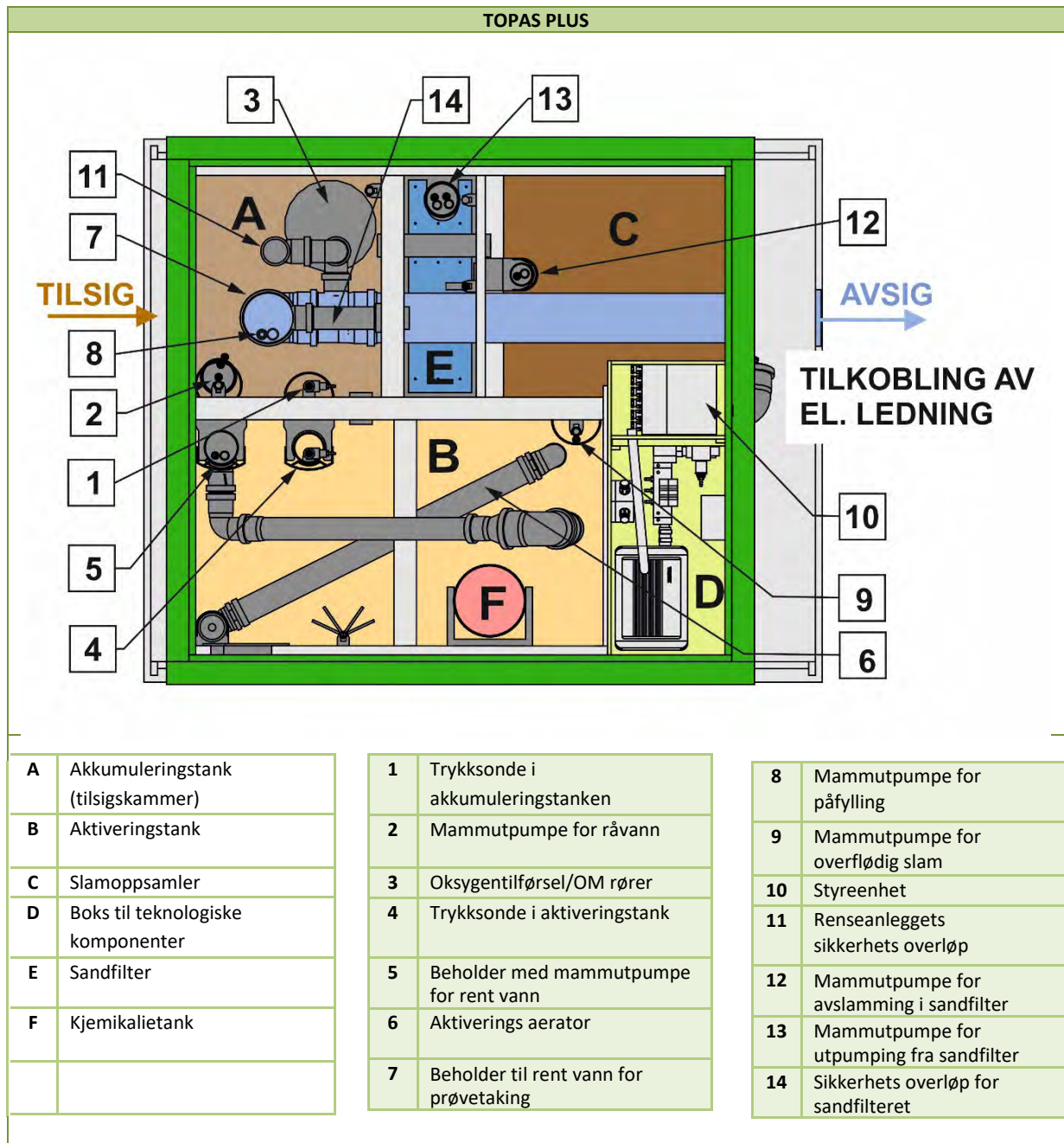
Fig. 2: Grunnrisskjema TOPAS Plus
